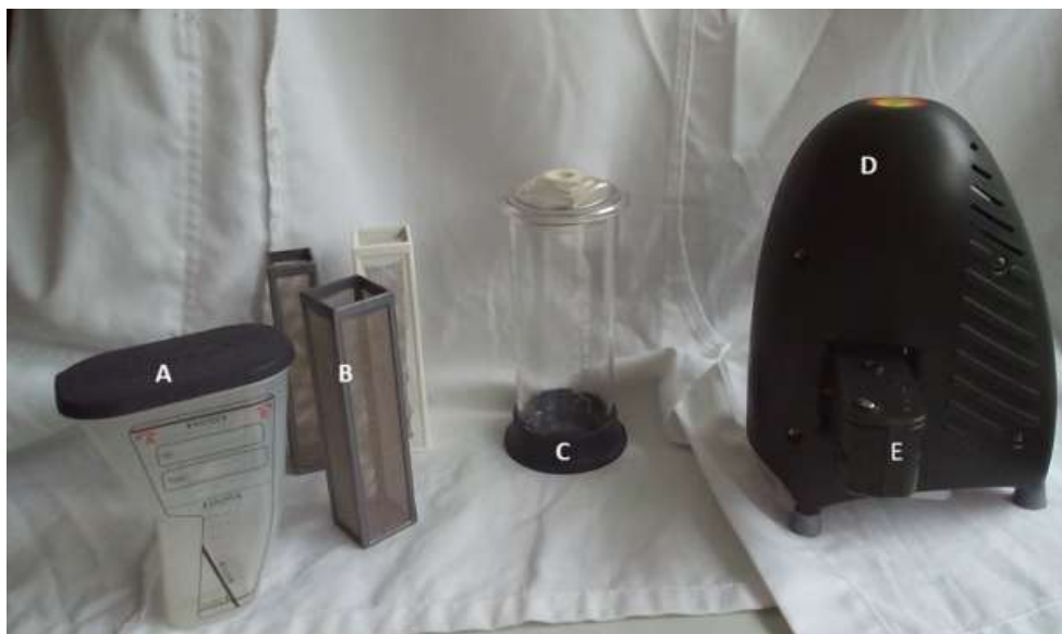
Figura 19: attrezzatura del kit FECPAK G2 - A: sedimentatore, B: filtri, C: cilindro del filtro, D: Micro-I, E: cassetta FECPAK G2 inserita nel Micro-I (Tyson et al., 2020)
